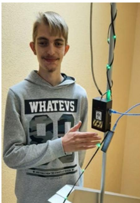
entworfen, die eine Nutzung mit einer wechselnden Einbahnregelung gewährleistet. Steht die Ampel auf Grün, darf die Treppe begangen werden. Zeigt sie Rot an, muss zunächst berührungslos mittels Infrarotsensor die Freigabe angefordert werden.
